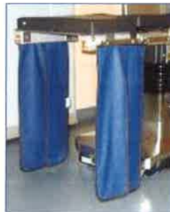
Écrans de protection : bas volets et vitre au plomb (J.L.REHEL/IRSN)
